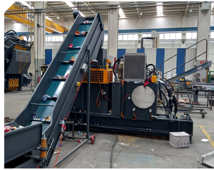
Geri dönüşüm kutu presi hidrolik sistemi
